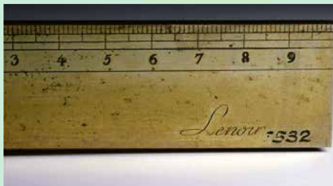
Um das neue Meter-Maß zu verbreiten, wurden Maßstäbe zum Eichen benötigt. Étienne Lenoir (1744–1832), der das hier abgebildete Instrument baute, hatte auch die beiden ersten Ur-Meter hergestellt. (Bild: Deutsches Museum)
